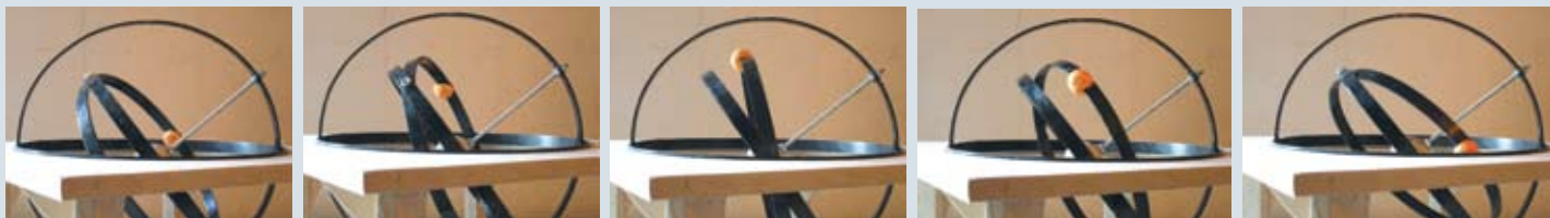
Figura 8. Esfera armilar regulada para mostrar las posiciones del Sol vistas por un habitante de Buenos Aires en distintas horas del solsticio de verano austral.
