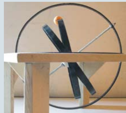
Figura 7. Esfera armilar regulada para los habitantes del hemisferio sur y para indicar la posición del Sol a mediodía en el solsticio del verano austral.
